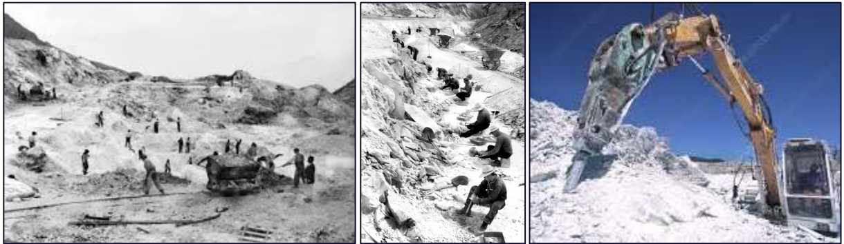
Exploitation du filon de talc manuellement jusqu'en 1960 (photo centrale), par engins mécaniques aujourd'hui
