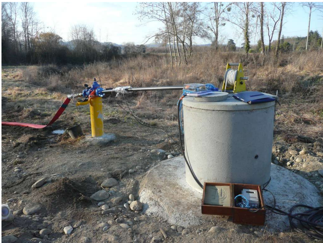
Pompage à P4, Pz1 en piézomètre, rejet des eaux envoyé à l'Ariège pour le test de longue durée.
