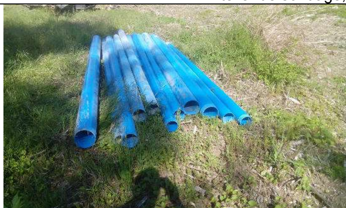
Tubs et crépines PCV, vissés ; 112x125 (4") et 163x180 mm (6")
