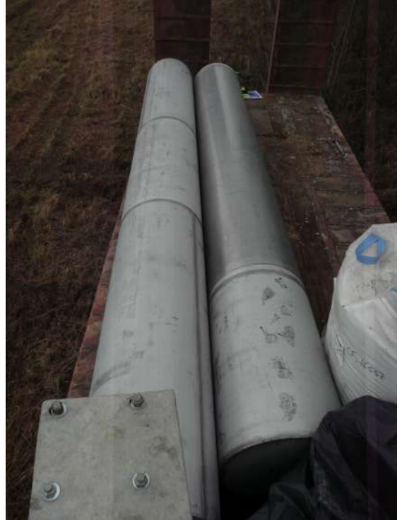
Tubes et crépines inox, soudées ; 600x610 (24"), tube sédimentier, fond soudé
